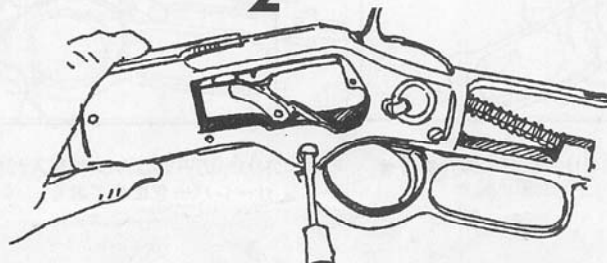
サイドプレートスクリューを外し、右左のサイドプレートを取る。ローアフレームは後のスクリューから順に外して下さい。
